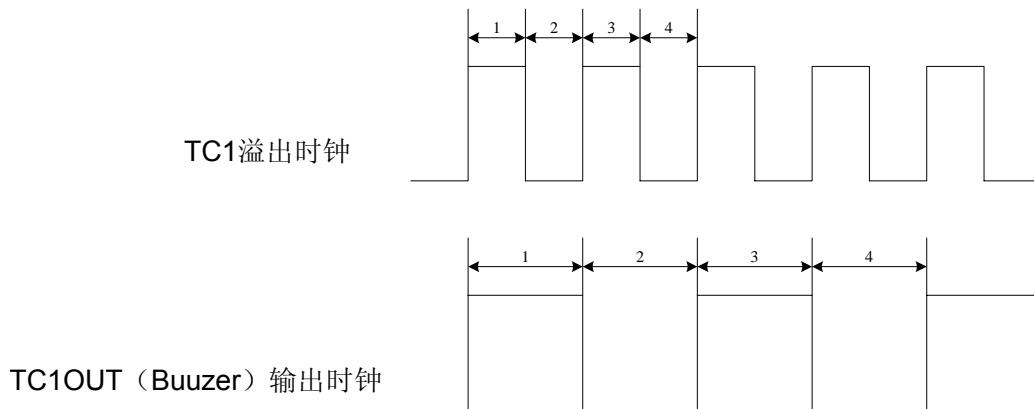
若外部高速时钟选择 4MHz，系统时钟源采用外部时钟 Fosc/4，程序中设置 TC1RATE2~TC1RATE1 = 110， TC1C = TC1R = 131，则 TC1 的溢出频率为 2KHz，TC1OUT 的输出频率为 1KHz。下面给出范例程序。
