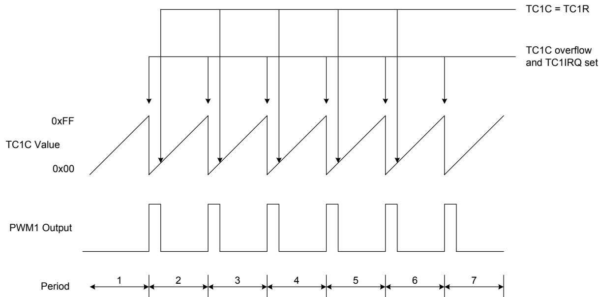
上图所示是 TC1R 恒定时的波形。每当 TC1C 溢出时，PWM 都输出高电平， $TC1C \geq TC1R$  时，PWM 即输出低电平。下面所示是 TC1R 发生变化时对应的波形图：
