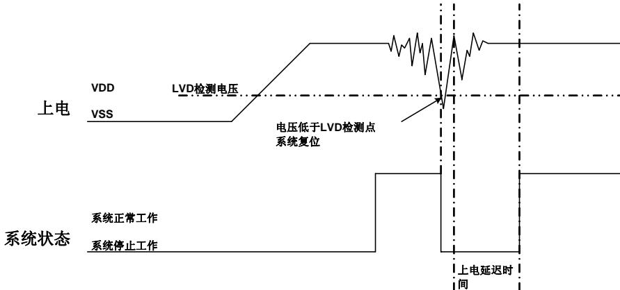
低电压检测（LVD）是 SONiX 8 位单片机内置的掉电复位保护装置，当 VDD 跌落并低于 LVD 检测电压值时，LVD 被触发，系统复位。不同的单片机有不同的 LVD 检测电平，LVD 检测电平值仅为一个电压点，并不能覆盖所有死区范围。因此采用 LVD 依赖于系统要求和环境状况。电源变化较大时，LVD 能够起到保护作用，如果电源变化触发 LVD，系统工作仍出错，那么 LVD 就不能起到保护作用，就需要采用其它复位方法。
