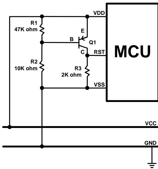
电压偏置复位电路是一种简单的LVD电路，基本上可以完全解决掉电复位问题。与稳压二极管复位电路相比，这种复位电路的检测电压值的精确度有所降低。电路中，R1和R2构成分压电路，当VDD高于和等于分压值“ $0.7V \times (R1 + R2) / R1$ ”时，三极管集电极C输出高电平，单片机正常工作；VDD低于“ $0.7V \times (R1 + R2) / R1$ ”时，集电极C输出低电平，单片机复位。
