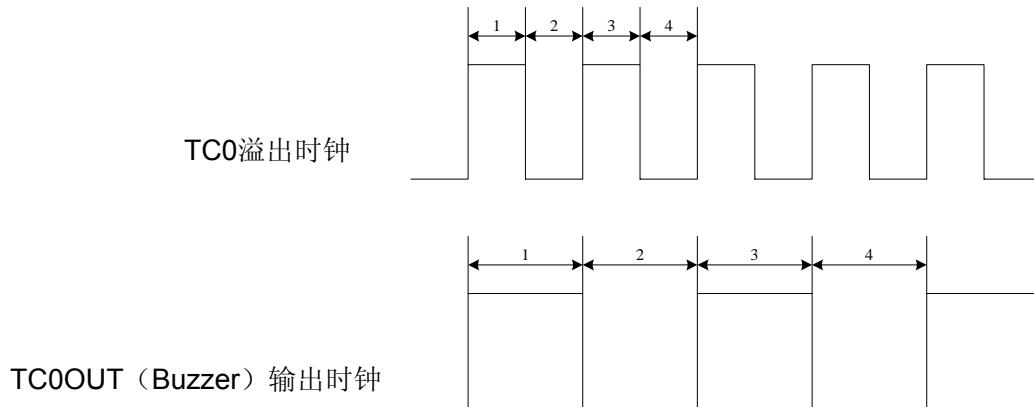
若外部高速时钟选择 4MHz，系统时钟源采用外部时钟 Fosc/4，程序中设置 TC0RATE2~TC0RATE1 = 110， TC0C = TC0R = 131，则 TC0 的溢出频率为 2KHz，TC0OUT 的输出频率为 1KHz。下面给出范例程序。
