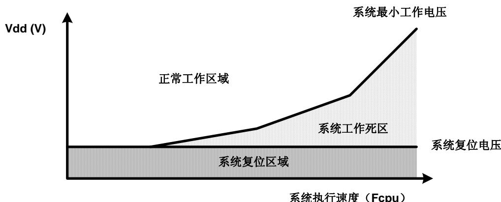
如上图所示，系统正常工作电压区域一般高于系统复位电压，同时复位电压由低电压检测（LVD）电平决定。当系统执行速度提高时，系统最低工作电压也相应提高，但由于系统复位电压是固定的，因此在系统最低工作电压与系统复位电压之间就会出现一个电压区域，系统不能正常工作，也不会复位，这个区域即为死区。
