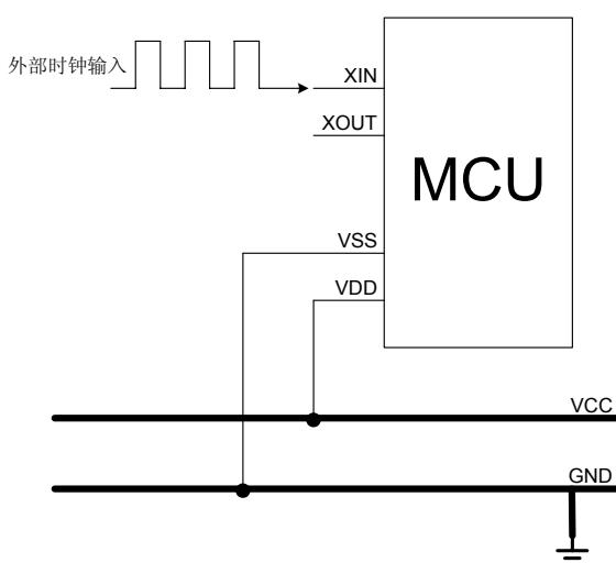
\* 注：外部振荡电路中的 GND 必须尽可能的接近单片机的 VSS 端口。
