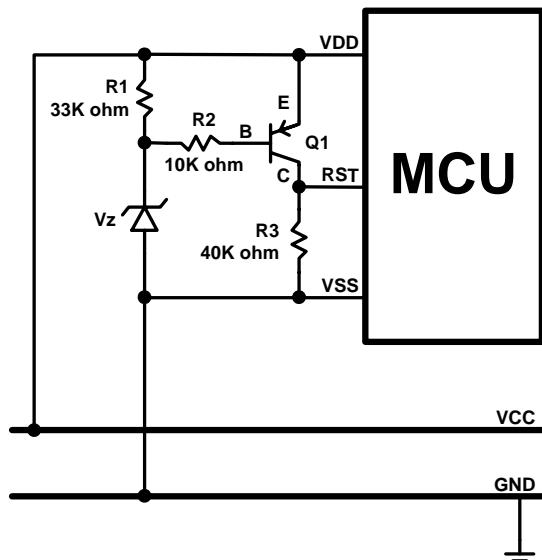
稳压二极管复位电路是一种简单的LVD电路，基本上可以完全解决掉电复位问题。如上图电路中，利用稳压管的击穿电压作为电路复位检测值，当VDD高于“ $V_z + 0.7V$ ”时，三极管集电极输出高电平，单片机正常工作；当VDD低于“ $V_z + 0.7V$ ”时，三极管集电极输出低电平，单片机复位。稳压管规格不同则电路复位检测值不同，根据电路的要求选择合适的二极管。
