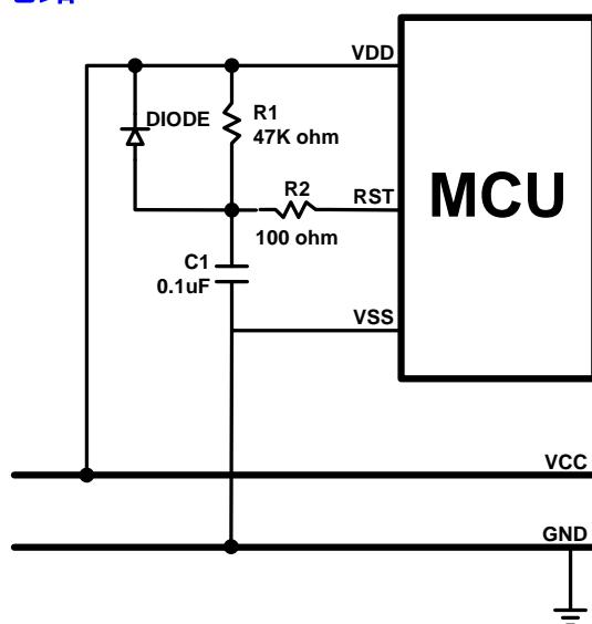
上图中，R1 和 C1 同样是为复位引脚提供输入信号。对于电源异常情况，二极管正向导通使 C1 快速放电并与 VDD 保持一致，避免复位引脚持续高电平、系统无法正常复位。
