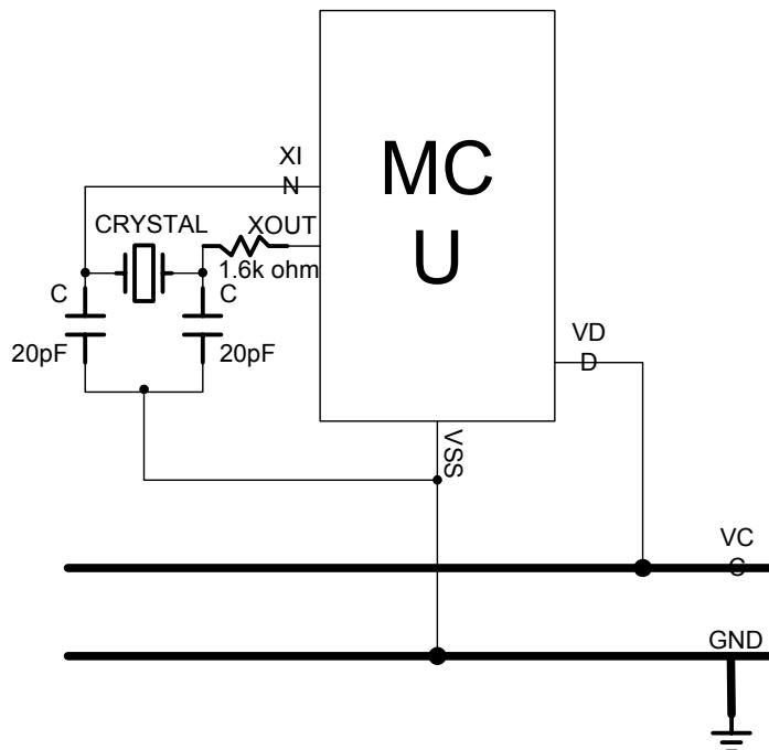
\* 注：上图中， XIN/XOUT/VSS 引脚与石英振荡器以及电容 C 之间的距离越近越好。
